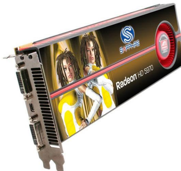
Рисунок 2.30. Двухпроцессорная видеокарта Radeon HD 5970
