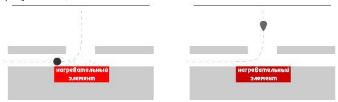
Рисунок 2.34. Принцип технологии drop-on-demand фирмы Hewlett-Packard
