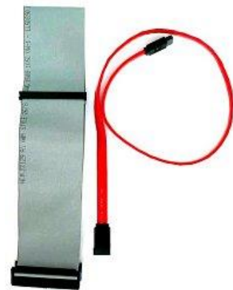
Рисунок 2.13. Кабели подключения IDE и SATA
