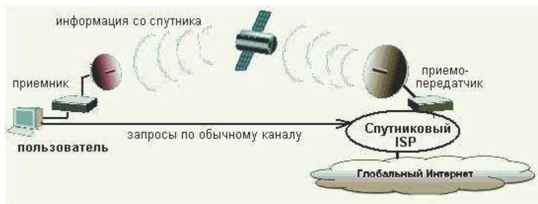
Рисунок 4.7. Схема асимметричного спутникового доступа в Интернет
