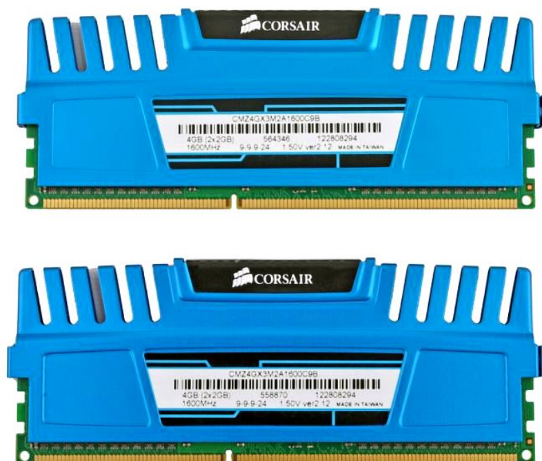
Рисунок 2.14. Модули памяти 4Gb (2x2Gb) PC3-12800 1600MHz DDR3 DIMM Corsair Vengeance XMS3
