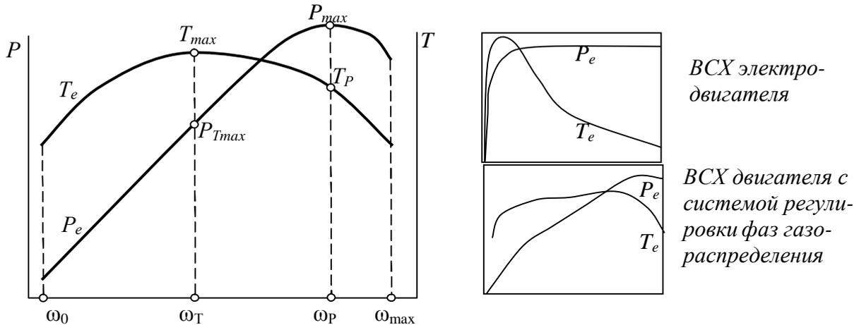
$\omega_0$  – min устойчивая под нагрузкой угловая скорость двигателя;
