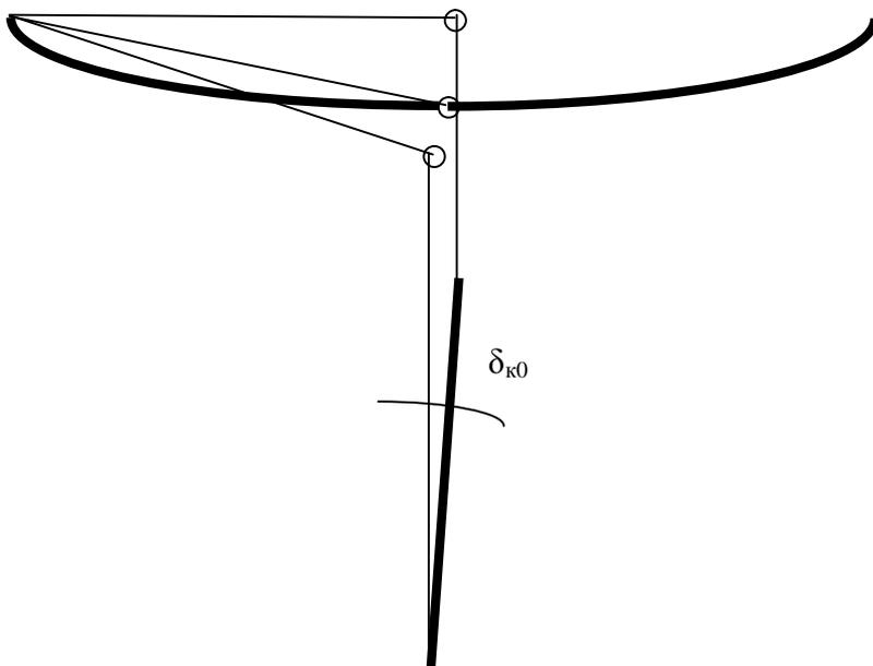
$\delta_{\text{к0}}$  – кинематический увод оси вызван разворотом оси при крене кузова
