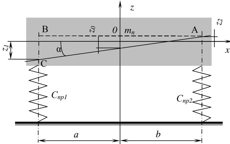
После таких допущений остается 2 степени свободы: вертикальное перемещение  $z_0$  и поворот  $\alpha$  в продольной вертикальной плоскости. Оба эти движения вызывают изменение прогибов  $z_1$  и  $z_2$  упругих элементов и возникновению сил  $C_{np1} \cdot z_1$  и  $C_{np2} \cdot z_2$  действующих со стороны этих элементов на подрессоренную массу.
