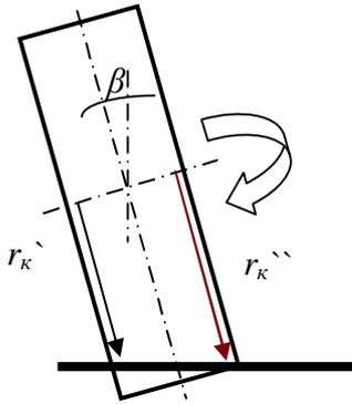
1. *Зависимая подвеска.* Крен кузова не вызывает наклона плоскости вращения колес (за счет кинематики). Однако перераспределение вертикальных реакций приводит к различной деформации колес, а, следовательно, и к наклону оси.
