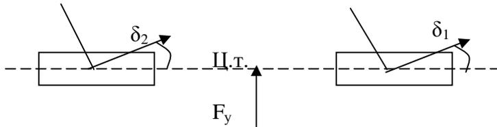
Автомобиль боком «сползает» с дороги. Коррекция рулем легко компенсирует возмущение. Автомобиль движется «немного боком» к курсу.
