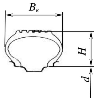
Радиальные и диагональные шины отличаются направлением укладки корда при их изготовлении, а также наличием брекера у радиальных. В обозначении радиальных шин присутствует буква **R** перед посадочным диаметром (не радиусом !!!).
