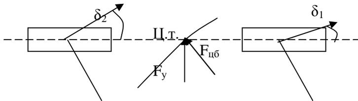
При воздействии боковой силы появляется центробежная сила, которая *не* гасит возмущение. Автомобиль не устойчив. Курс меняется, коррекция рулем возможно (не всегда!!!) компенсирует это изменение. Автомобиль движется боком, передние колеса повернуты.
