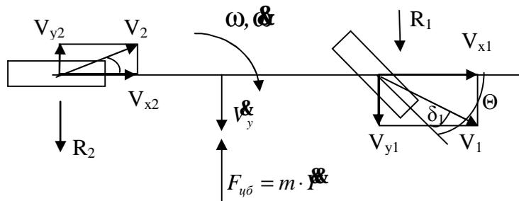
Рассмотрим два последовательных положения автомобиля через интервал времени  $\Delta t$  и спроецируем новые скорости на старые, затем вычтем старые:  $\Delta \bar{V}_y = (V_y + \Delta V_y) \cdot \cos \Delta \varphi + (V_x + \Delta V_x) \cdot \sin \Delta \varphi - V_y$ ;
