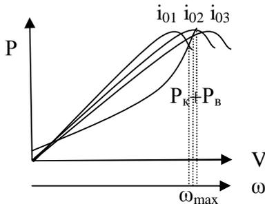
Чем медленнее главная передача (больше передаточное число  $i_0$ ), тем больше крутящий момент на колесе, следовательно, больше запас мощности, но меньше процент загрузки двигателя и экономичность автомобиля.
