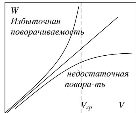
$$V_{кр} = \sqrt{\frac{g \cdot L}{\frac{G_2}{K_2} - \frac{G_1}{K_1}}} - \text{критическая скорость} - \text{скорость, при которой радиус}$$
