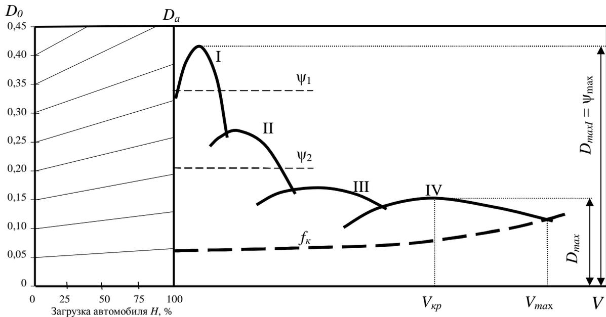
*Примечания:* Масштабы осей  $D_a$  и  $D_0$  обратно пропорциональны весу соответственно груженого и снаряженного автомобиля  $D_0 = D_a \frac{G_a}{G_0}$ .
