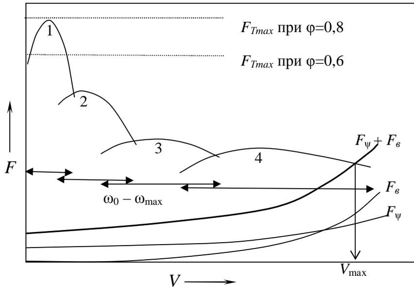
Сила тяги автомобиля характеризуется набором кривых, зависящих от передаточного числа трансмиссии
