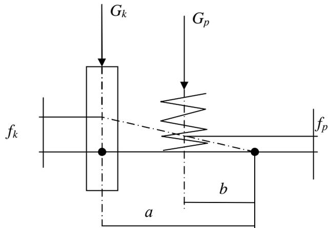
Где индексы  $k$  и  $p$  соответствуют колесу и рессоре (упругому элементу)
