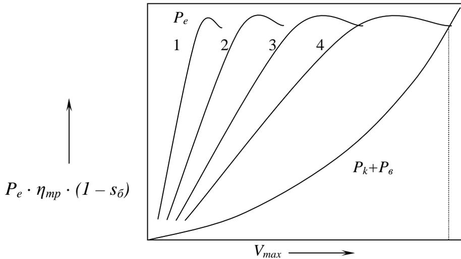
Для исключения радиусов колеса введем мощность скоростных потерь (буксование колес:  $s_{\delta} = 1 - r_k / r_{k0}$ ):
