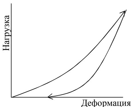
При *нагружении* колеса преодолеваем силу упругости и силу внутреннего трения в материале шины. При *разгрузении* сила упругости восстанавливает форму шины, а сила внутреннего трения в материале шины вновь сопротивляется (петля *гистерезиса*). Таким образом, в процессе нагружения – разгрузки шины часть энергии затрачивается на внутреннее
