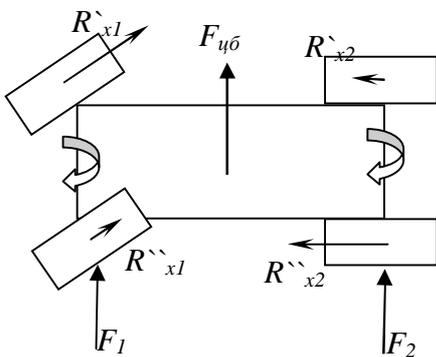
**Перераспределение** продольных реакций  $R_x$  между бортами на каждой оси неодинаково: На ведомой оси перераспределение в пользу внешнего колеса, а на ведущей в пользу внутреннего (вертикальная реакция входит со знаком «минус», кроме того, у оси с самоблокирующимся дифференциалом положительный момент больше у внутреннего колеса, что усугубляет перераспределение):
