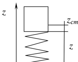
Сила, развиваемая упругим элементом, пропорциональна его жесткости и прогибу:
