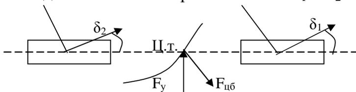
При воздействии боковой силы появляется центробежная сила, которая гасит возмущение. Автомобиль устойчив. Курс немного меняется, но коррекция рулем компенсирует это изменение. Автомобиль движется прямо, но передние колеса немного повернуты.
