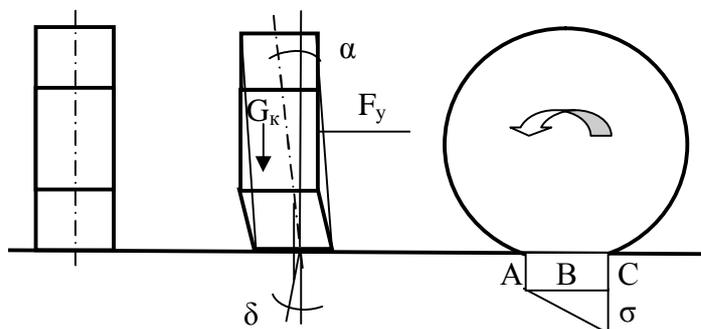
Если на вращающееся колесо начнет действовать боковая сила, то вектор скорости колеса отклонится от первоначального на некий угол  $\delta$  – угол силового увода (угол между линией пересечения плоскости вращения колеса с дорогой и вектором скорости колеса):
